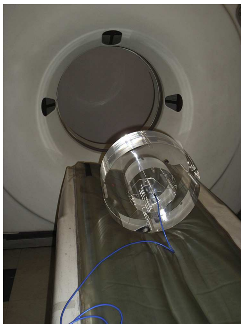
Figura 4 Fantoma abdominal y craneal de acrílico (PMMA) donde puede observarse la cámara de ionización colocada en el orificio central.
